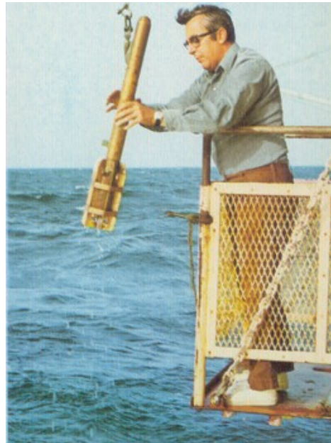
Medida de la temperatura de las aguas oceánicas por medio de un batitermógrafo.
